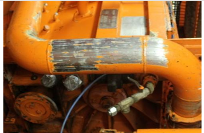
Effektiv fjerning av gammel maling og korrosjon
