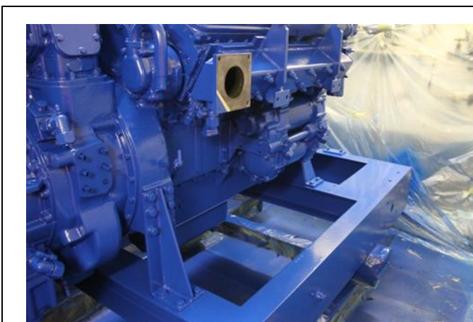
Etter påføring av toppstrøk.
