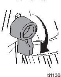
Avtrekker usikret (sprøyting)
